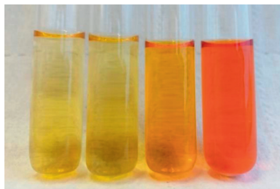
Abb. 3: Probe nach Pauly (v.l.n.r.: Blindprobe, Phenylalanin, Histidin, Tyrosin, jeweils 0,5 mmol)
