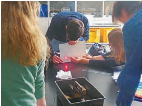
▲ Die Messwerte eines Beugungsbildes einer Gitterstruktur, die der 2D-Ansicht einer DNA nachempfunden ist, werden erfasst.
