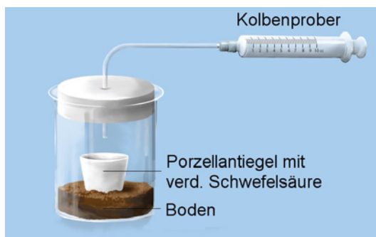
Abbildung 13: Bestimmung des Kalkgehaltes (zum Beispiel im Boden).
