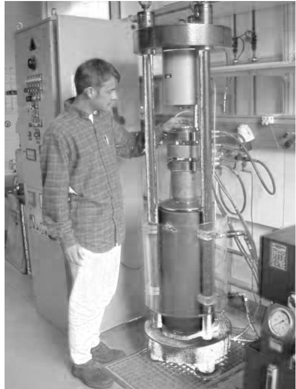
Abbildung 1: Eine Stempel-Zylinder-Pressen. In der Mitte die hydraulische Presse. Die Druckübertragung erfolgt von oben und unten über zwei wassergekühlte Druckscheiben auf die ebenfalls wassergekühlte Matrize. Der Einbau mit der Probenkapsel (Abb. 2) befindet sich im Zentrum dieser mittleren Scheibe. Auf der Rückseite erkennt man die Anschlüsse für Kühlwasser und Heizstrom. Auf der Vorderseite das Thermoelement, welches die Proben temperatur misst. Links der Regelschrank für Temperatur und Drucksteuerung, rechts vorne der Kompressor der hydraulischen Presse.
