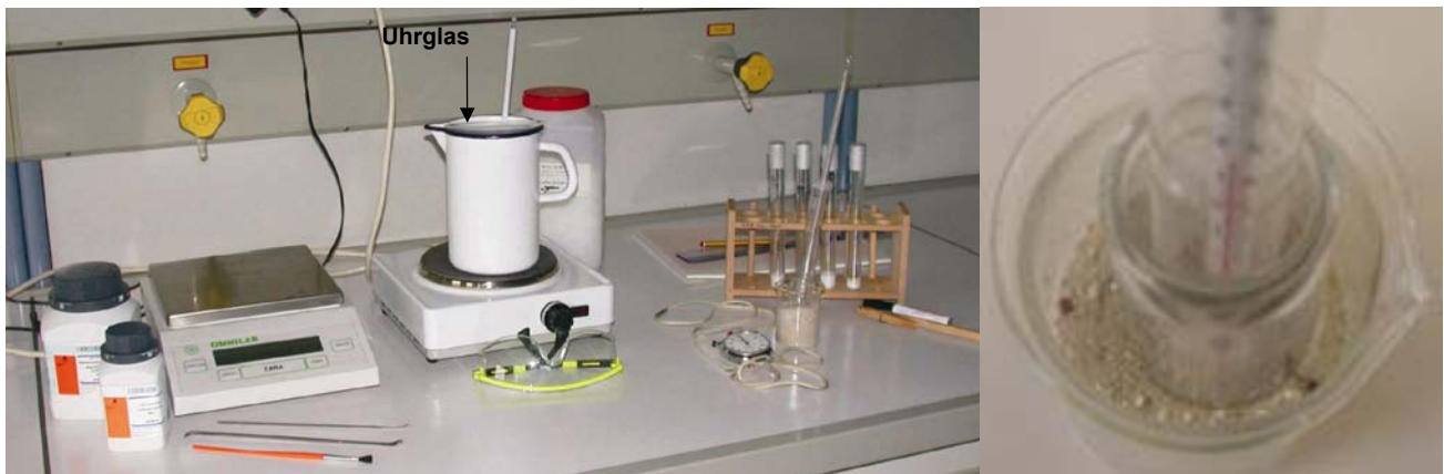
Abbildung 3: Übersicht über die für den Versuch benötigten Materialien. Rechts: Isoliergefäß, das aus 2 ineinander gestellten Bechergläsern besteht. Die Zwischenschicht wurde mit Sand verfüllt. Die Reagenzgläser müssen zum Ermitteln der Abkühlungskurven zügig in das Isoliergefäß gestellt werden (der Versuch wurde stark vereinfacht nach LINDEMANN 1999).
